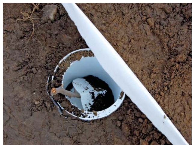
Fot. 58. Zabezpieczenie pułapki. Pokrywa z wyciętym otworem tworzy kotłownię, który utrudnia płazom wyjście. Na dnie zgięty fragment wyciętej części pokrywy, pełniący dla płazów funkcję ochrony przed słońcem i kryjówki przed drapieżnikami. Kotek po lewej umożliwia wyjście z pułapki małym ssakom
